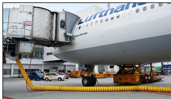
Figure 7: unité PCA (source : aéroport de Munich)
