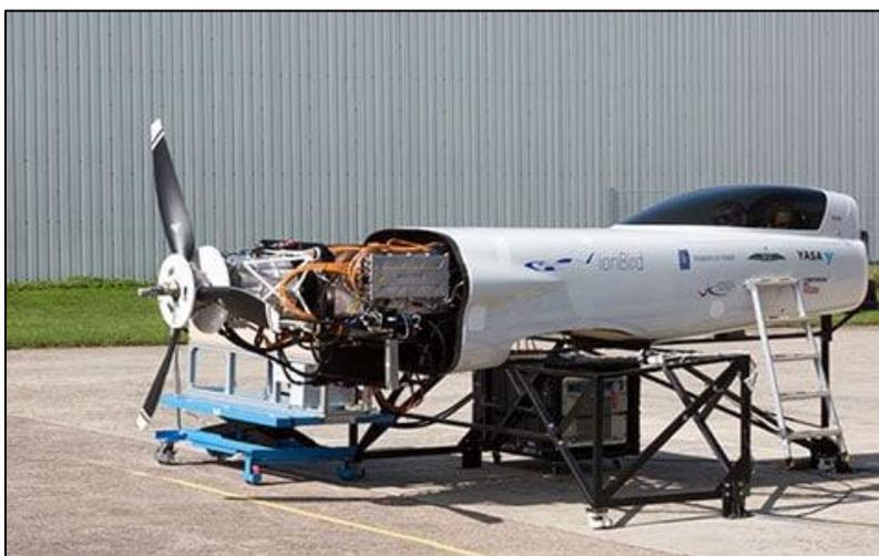
Figure 28 : Technologie alimentant l'avion testée sur « ionBird » (source : Rolls-Royce, 2020)
