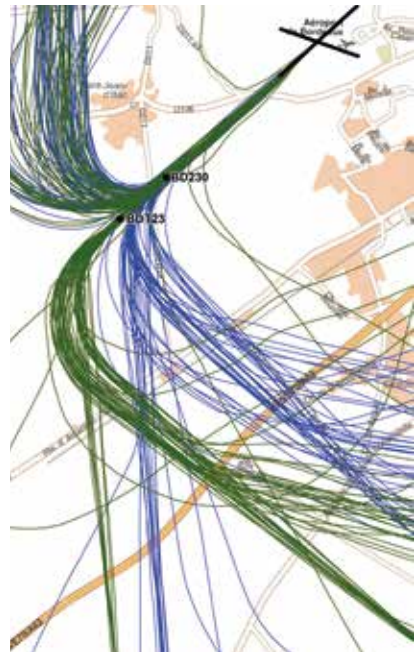
Saint-Denis de La Réunion : la DSNA en collaboration avec la compagnie Air Austral a conçu une procédure RNP AR en piste 12 qui permet de disposer, en cas de situation météorologique difficile, d'une approche de précision sur la piste la plus longue, dédiée aux décollages et ne disposant pas d'ILS. Un atout important pour l'exploitation et la sécurité des vols !
