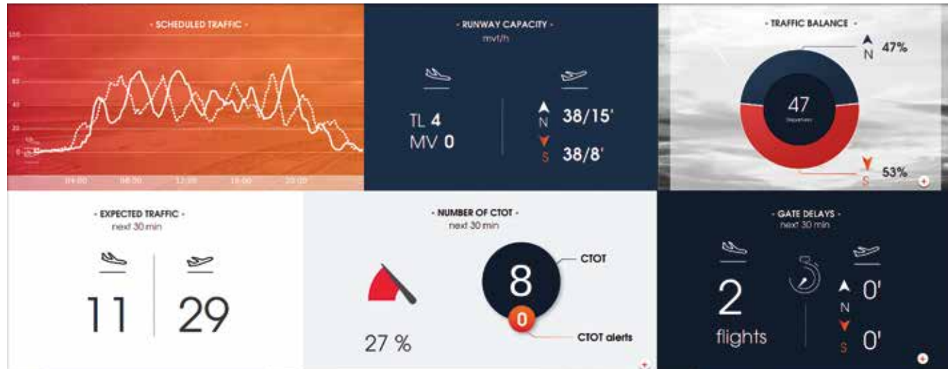
BigSky, une IHM multiservices pour la gestion des vols en TMA et sur l'aéroport. Les services de navigation aérienne de Paris-CDG ont conçu et mis en service en juin 2019 cet outil à l'IHM innovante, présentant un ensemble de services ATFCM et CDM sur un seul écran. Connecté au B2B@NM et aux données de l'aéroport, cet outil facilite les prises de décision pour la gestion des flux arrivées et départs, l'utilisation équilibrée des quatre pistes, les opérations lors des pointes de trafic...
