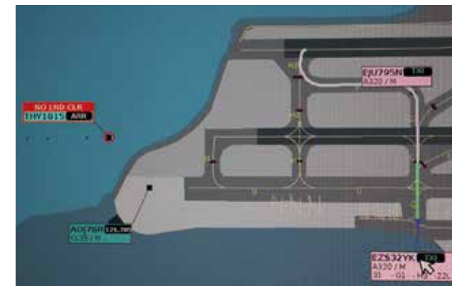
Organisme de contrôle aérien de Nice-Côte d'Azur : 15 contrôleurs ont testé ces nouveaux outils sur du trafic réel en mode sécurisé (shadow mode). Cet exercice a permis de préciser les bénéfices apportés en termes de prédictibilité, de sécurité et d'environnement ainsi que les besoins d'adaptation à un environnement donné et à ses spécificités.
