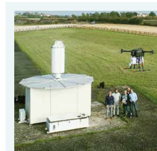
La DTI effectue la calibration des moyens de radionavigation au sol avec un Beech 250. Afin de déceler en amont d'éventuels problèmes d'émissions et de fiabilité des signaux d'une balise au sol, la DTI a testé la possibilité d'un contrôle en vol par drone. Une première expérimentation de mesures sur le VOR de Gaillac s'est ainsi tenue avec succès en octobre 2019. L'équipe de la DTI formée au pilotage de drone professionnel était accompagnée d'un instructeur d'une société privée.
