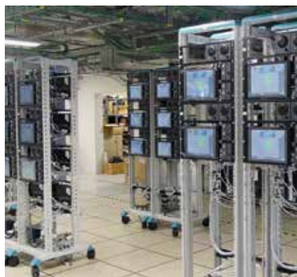
Projet N-VCS : tests d'endurance à la DTI sur plusieurs postes d'opérateurs.
