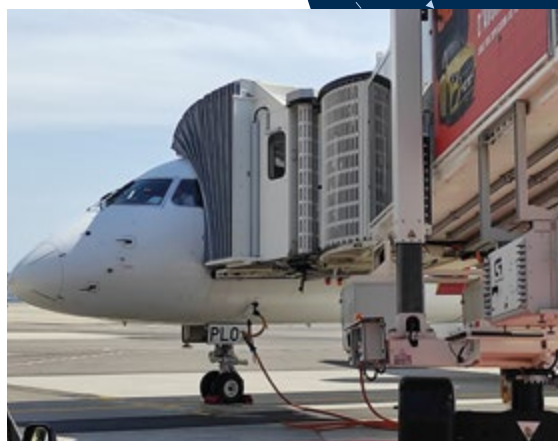
Embraer 190 de TAP Express à Nice – Côte d'Azur branché en 400 Hz en passerelle
