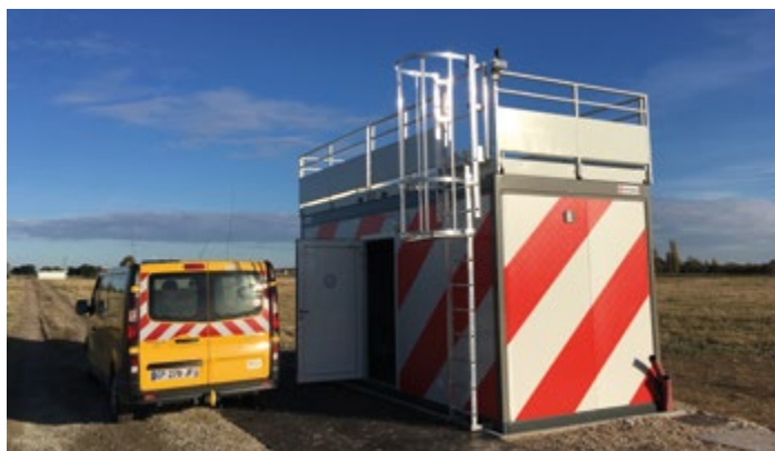
Station de mesure des polluants de l'air à l'aéroport de Paris – Charles-de-Gaulle
